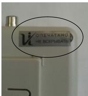
Рисунок 2 – Место пломбирования на задней панели корпуса (обведено)
